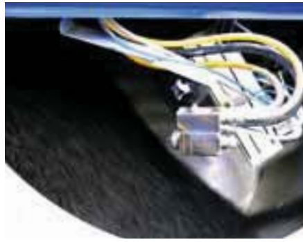
»3 Beschichtungsprozess im Trommel-Sprüh-Verfahren
