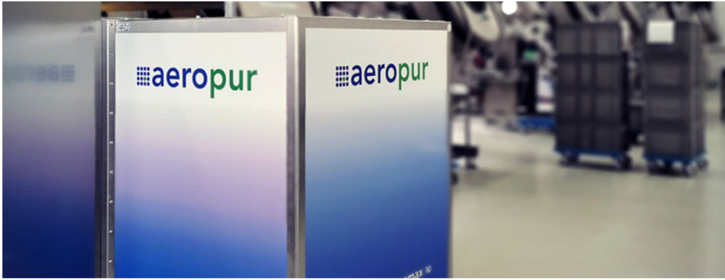
Staubfilter an Fenstern und Aeropur Luftreiniger sorgen für hochsaubere Produktionsbedingungen ohne Reinraumtechnologie (Bild: OVE Plasmatec)
