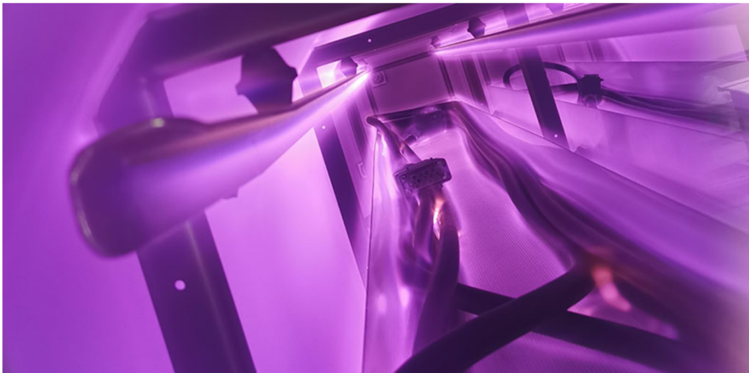
Durch das Plasmaverfahren werden nicht nur verbliebene oberflächliche Fertigungshilfsmittel entfernt, sondern auch ungebundene Mischungsbestandteile wie Weichmacher aus Elastomeren herausgelöst (Bild: OVE Plasmatec)
